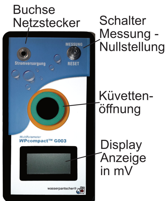
Abb. 1. Das Multifotometer Frontansicht mit den Bedienungselementen
